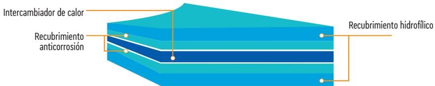
Estructura de las aletas del intercambiador de calor con doble recubrimiento
